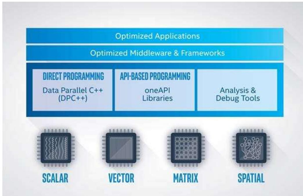
上の図に示すように、oneAPI プログラミング・モデルを利用するアプリケーションは、CPU から FPGA まで複数のターゲット・ハードウェア・プラットフォームで実行できます。インテルは、一連のツールキットの一部として oneAPI 製品を提供しています。インテル® oneAPI ベース・ツールキットと、インテル® oneAPI HPC ツールキット、インテル® oneAPI IoT ツールキット、およびその他のツールキットは、特定の開発者のワークロード要件を満たす補完的なツールを備えています。例えば、インテル® oneAPI ベース・ツールキットには、インテル® oneAPI DPC++/C++ コンパイラー、インテル® DPC++ 互換性ツール (インテル® DPCT)、ライブラリー、および解析ツールが含まれます。
