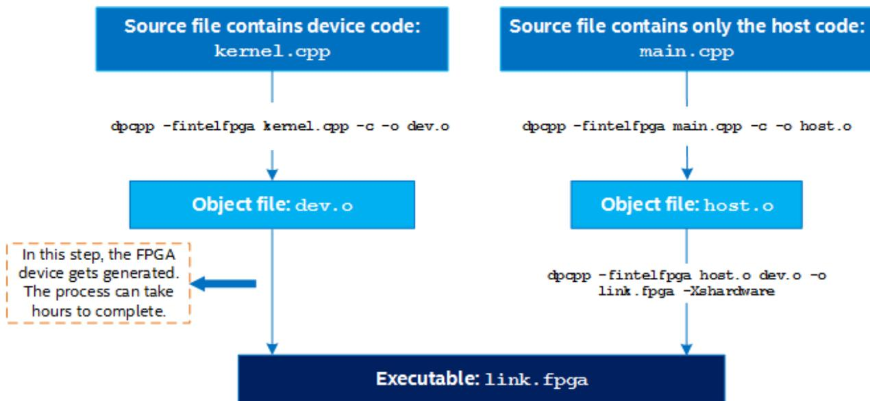
ホストコードを繰り返し処理し、FPGA デバイスのコンパイル時間が長くなるようにするには、デバイスリンクを使用してデバイスとホストのコンパイルを分離することを検討してください。
